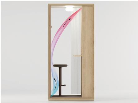
Die Luft tritt durch den Boden (Rückseite des Hockers) ein und strömt durch den Spalt an jeder Seite des Tischpanels (1 cm Abstand) wieder aus, der zum Anheben und Absenken des Tisches verwendet wird. Die Kabine hat einen Durchfluss von 115 m<sup>3</sup>/h (32 l/s) und 60 Luftwechsel pro Stunde innen. Der Nennvolumenstrom der Lüfter beträgt 120 m<sup>3</sup>/h.
