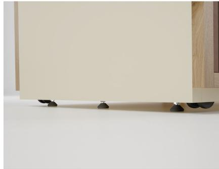
Um die Stabilität der Kabine sicherzustellen, sollte die Position der Stellfüße so angepasst werden, dass die Rollen angehoben werden. Dieser Vorgang kann mit einem Schraubenschlüssel durchgeführt werden, da die Stellfüße eine Mutter haben, die eine Anpassung ermöglicht. Zum Bewegen der Kabine müssen die Stellfüße erneut angehoben werden.
